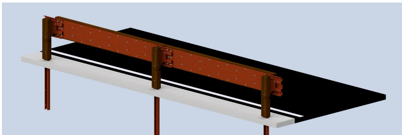
Figura 12 Vista posteriore della barriera con trattamento superficiale colore noce scuro
