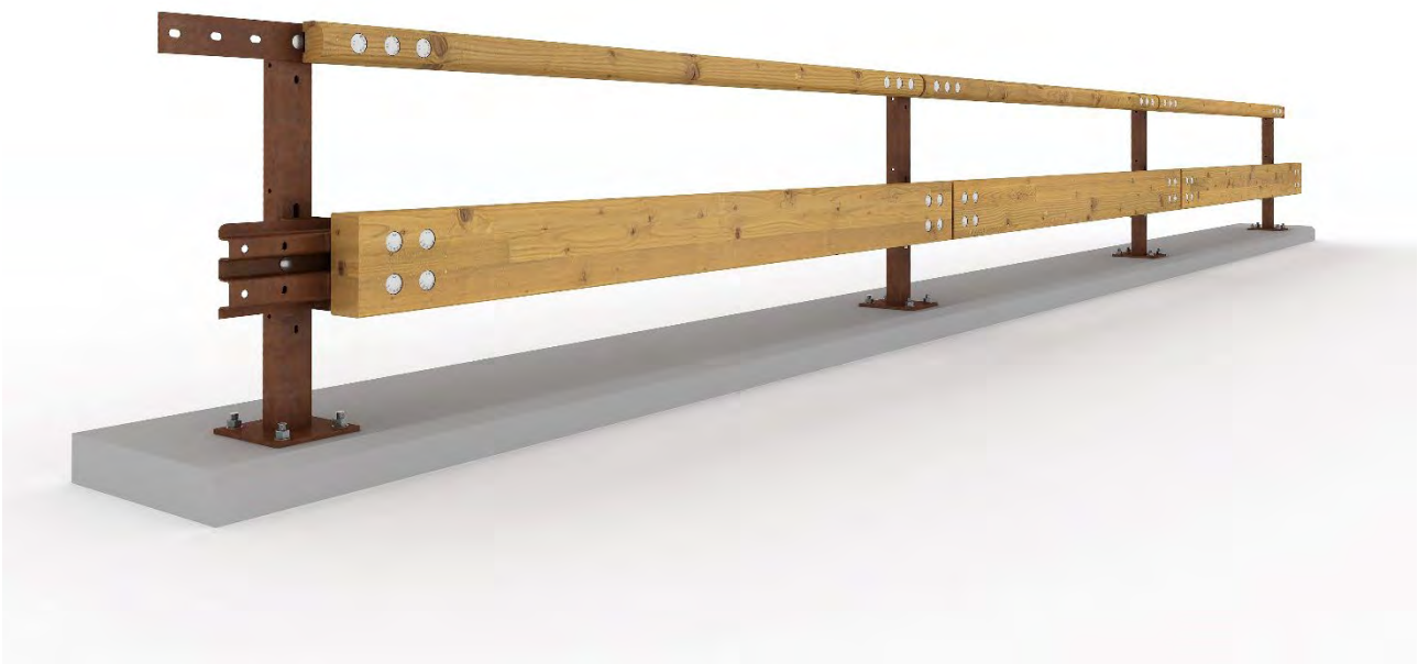
Figura 2 – Barriera senza rivestimento del montante
