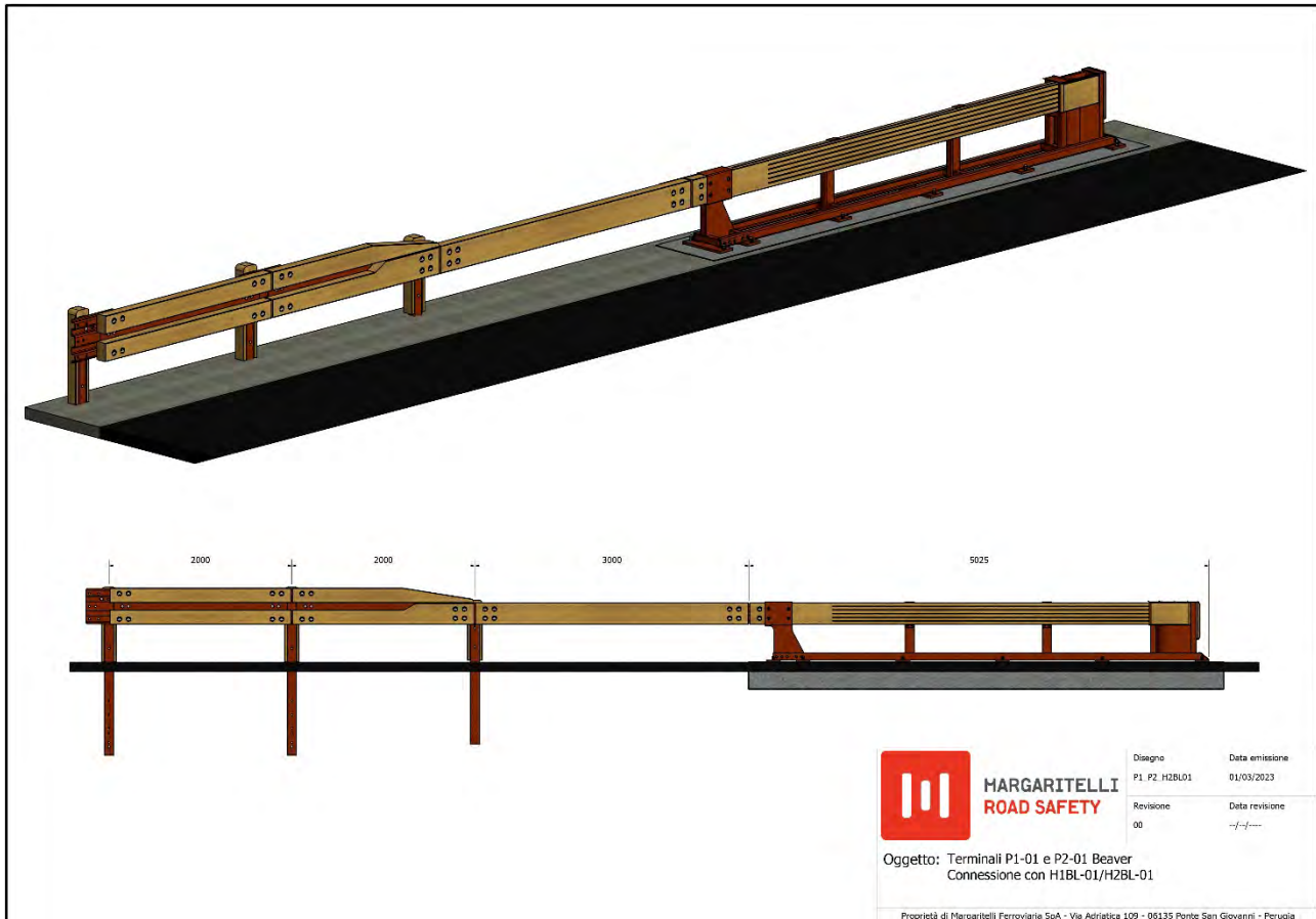
Figura 11 – Modalità di connessione del P1-01 e del P2-01 “Beaver” alla barriera
