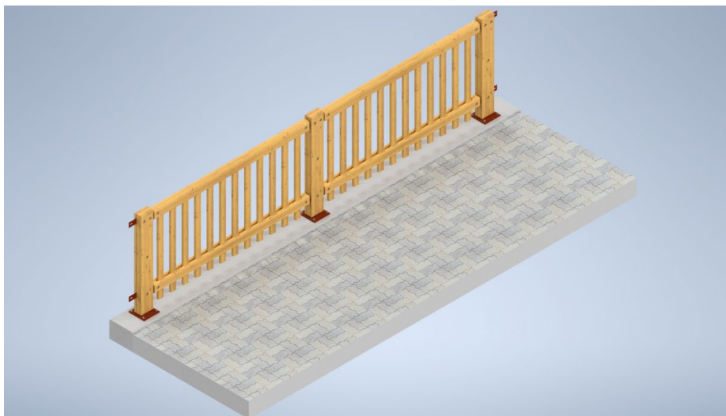
Figura 3. Montaggio del parapetto mediante montanti dotati di piastra di base
