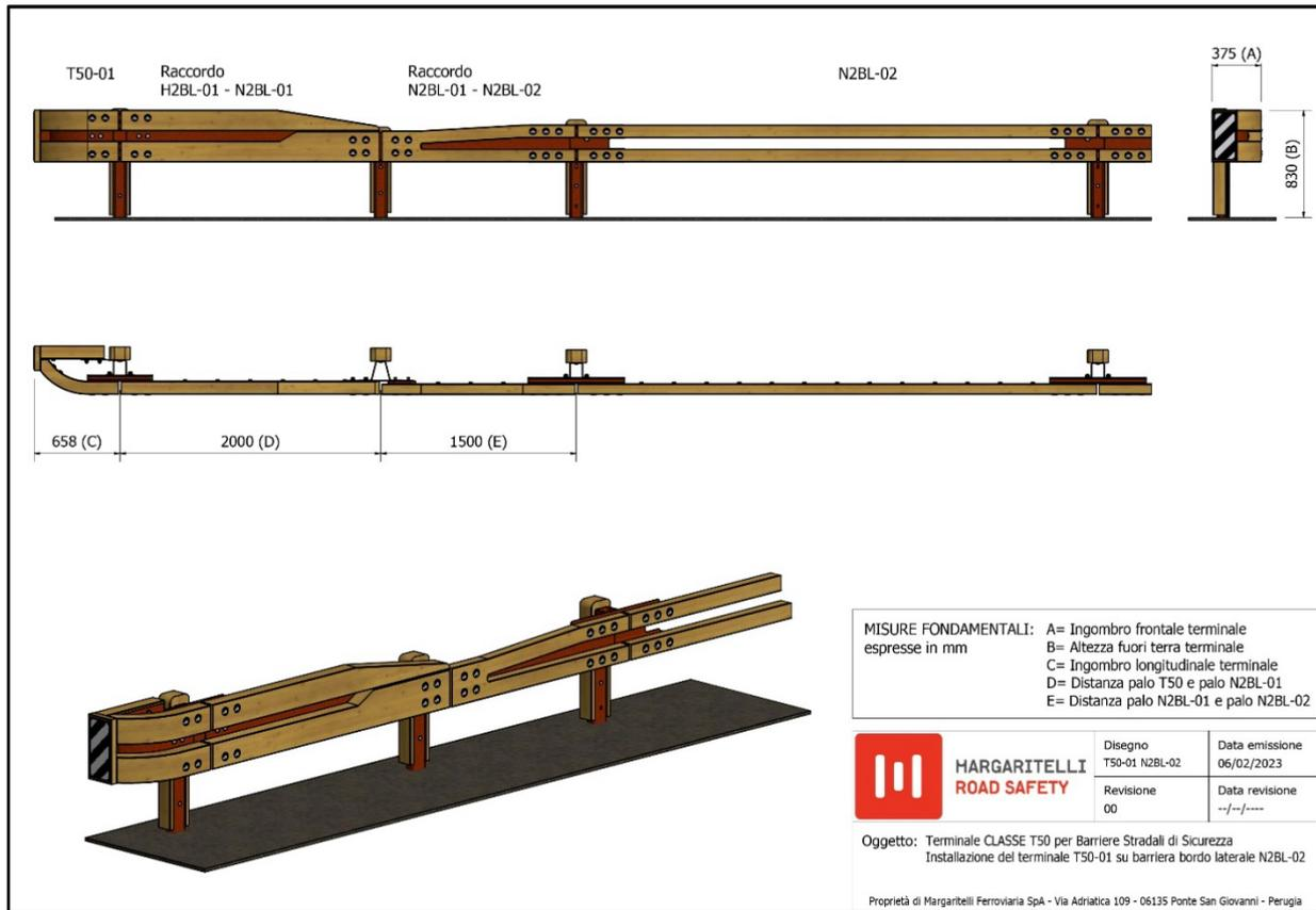
**Figura 8** schema della barriera con terminale T50-01
