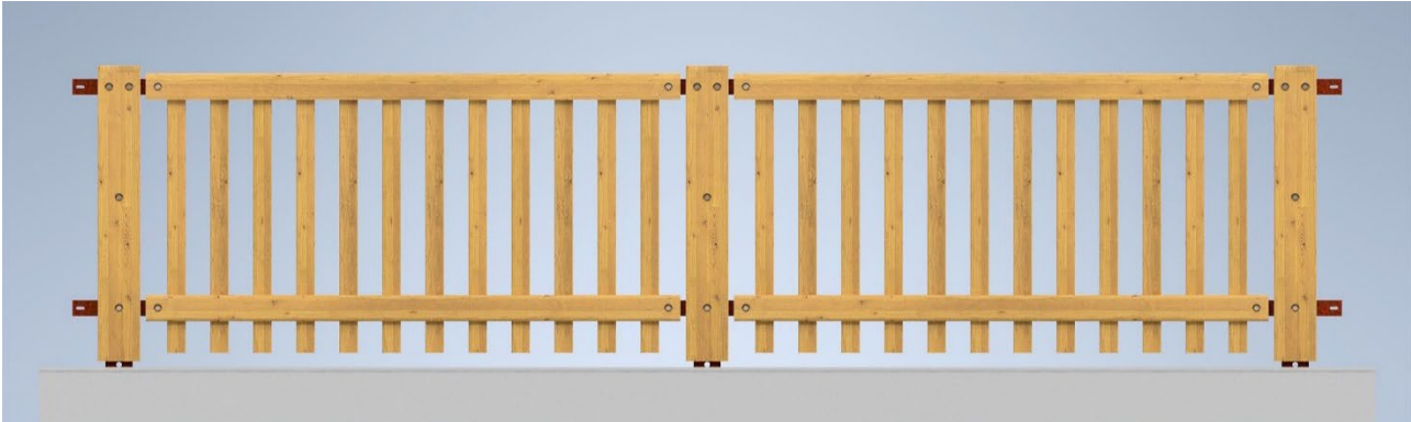
Figura 6. Montaggio del parapetto su fori predisposti nel cordolo di fondazione
