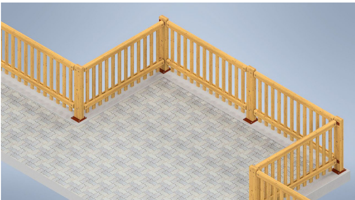
Figura 11. Montaggio del parapetto su struttura con angoli di 90 gradi – modalità B
