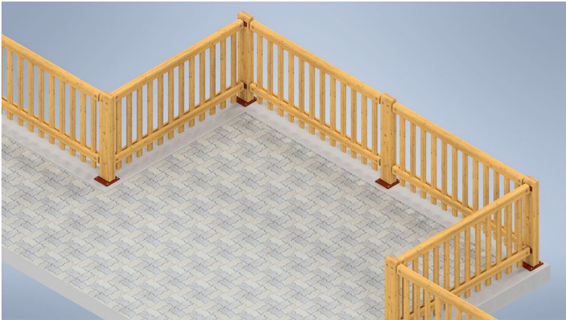
Figura 9. Montaggio del parapetto su struttura con angoli di 90 gradi – modalità A
