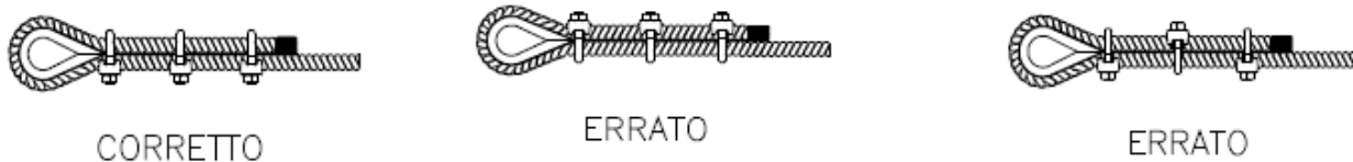
Figura 8 - Disposizione dei morsetti sulla fune di testa
