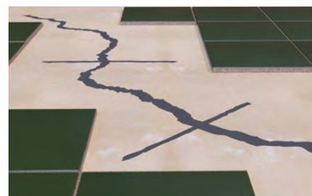
Sigillatura di fessure
