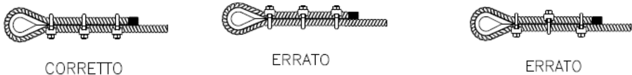
Figura 8 - Disposizione dei morsetti sulla fune di testa
