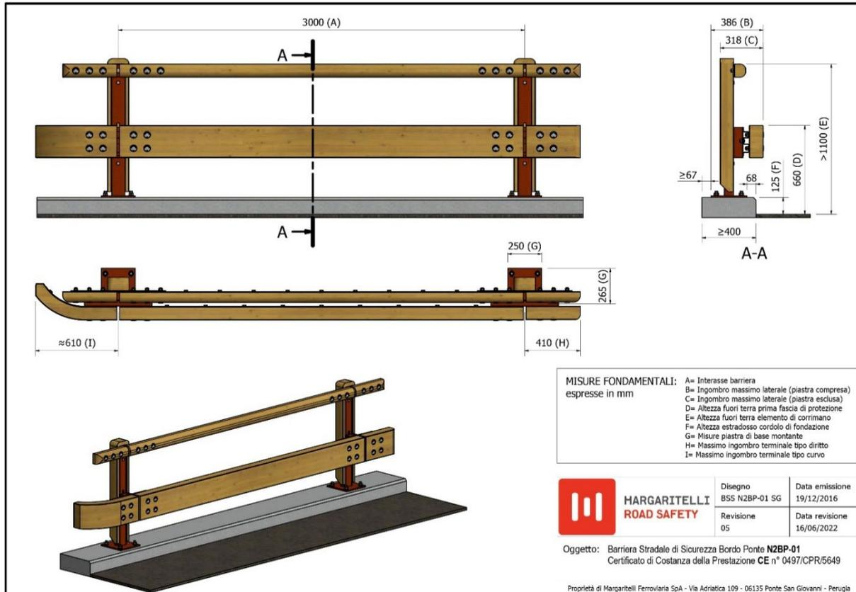
**Figura 5** schema della barriera in versione standard
