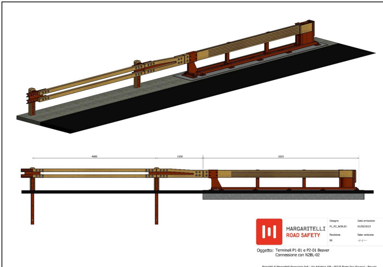
Figura 9 schema della barriera con terminali P1-01 e P2-01 Beaver
