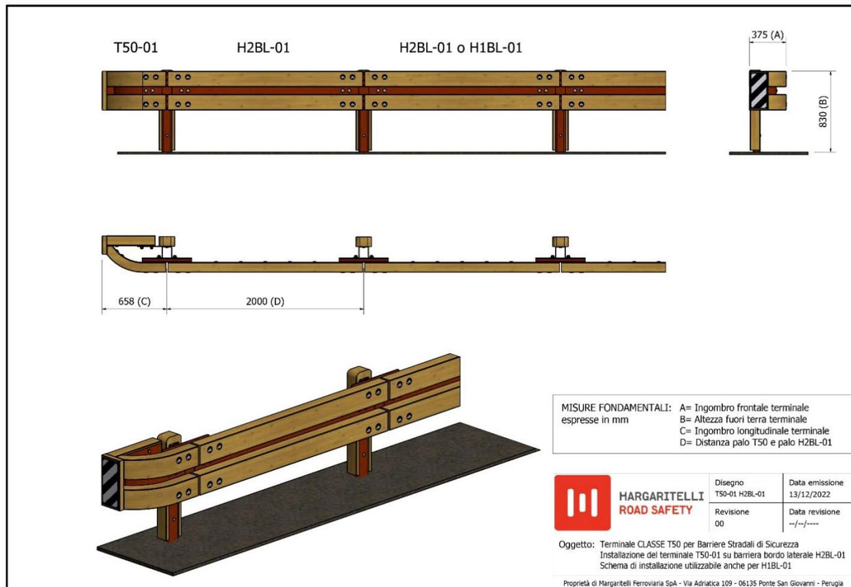
**Figura 5** schema di collegamento tra barriera bordo laterale e terminale T50-01**MATERIALI.****Acciaio.**
