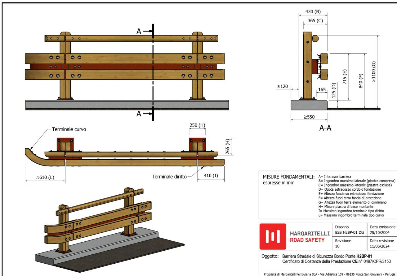
**Figura 3** schema della barriera in versione standard
