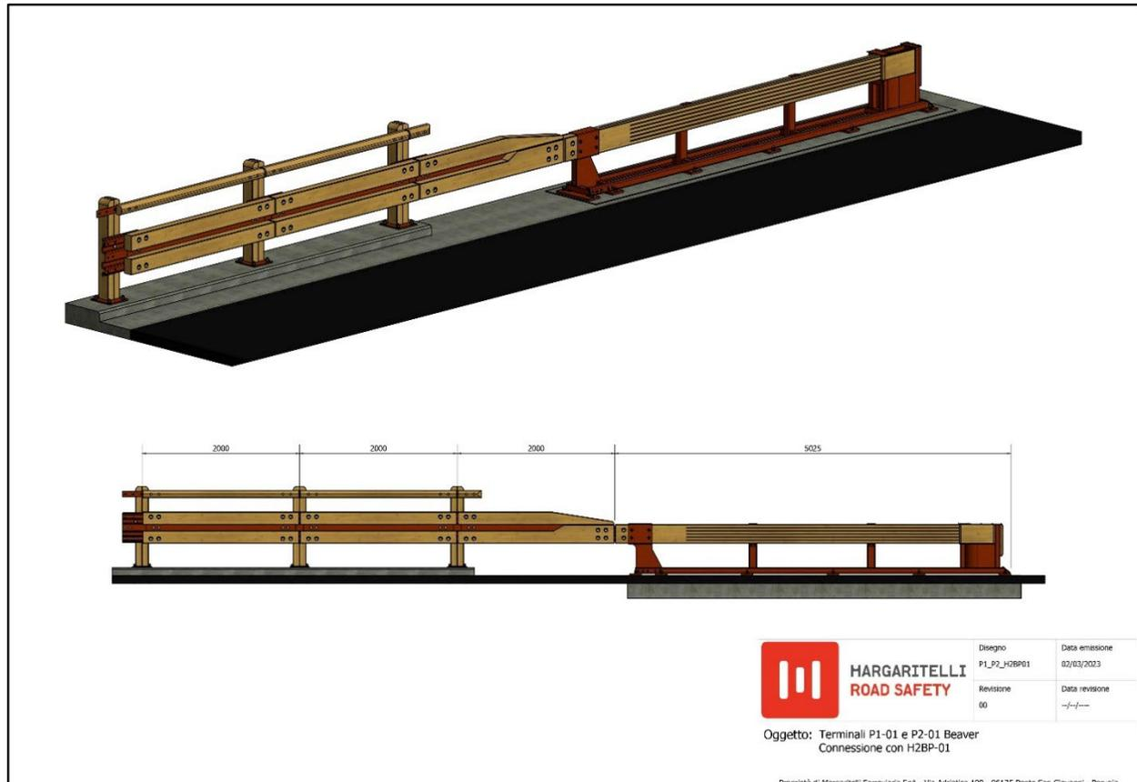
**Figura 4** schema della barriera con collegamento diretto con terminale P1-01 o P2-01 Beaver
