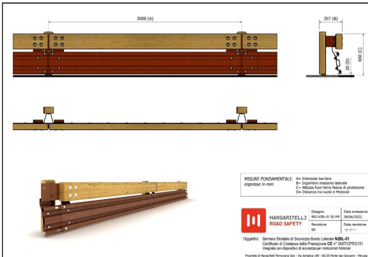
**Figura 9** schema della barriera N2BL-01 integrata con MotoRail
