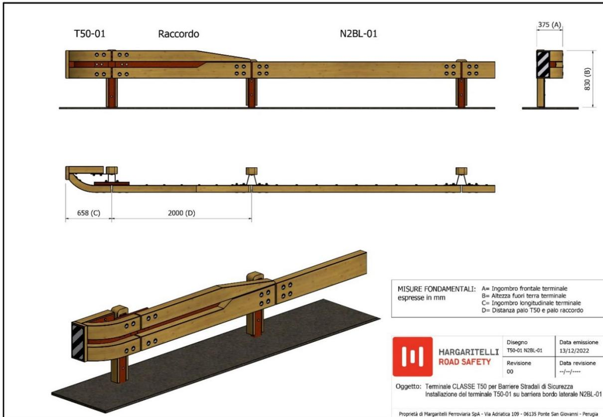
**Figura 10** schema della barriera con terminale T50-01
