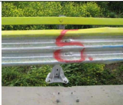
CASO 3: palo rigido – piastra rigida - rottura filettatura delle barre di ancoraggio
