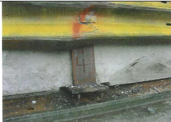
CASO 4: paletto rigido – piastra semi rigida - parziale sfilamento delle barre di ancoraggio
