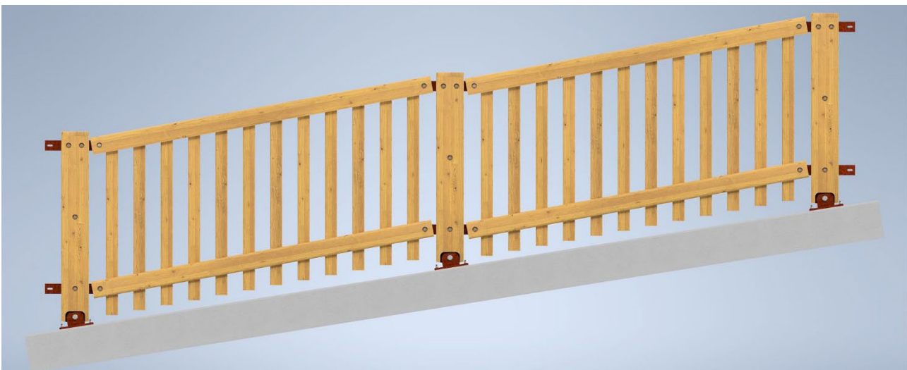
Figura 8. Montaggio del parapetto mediante montanti speciali con pendenza del 16 per cento
