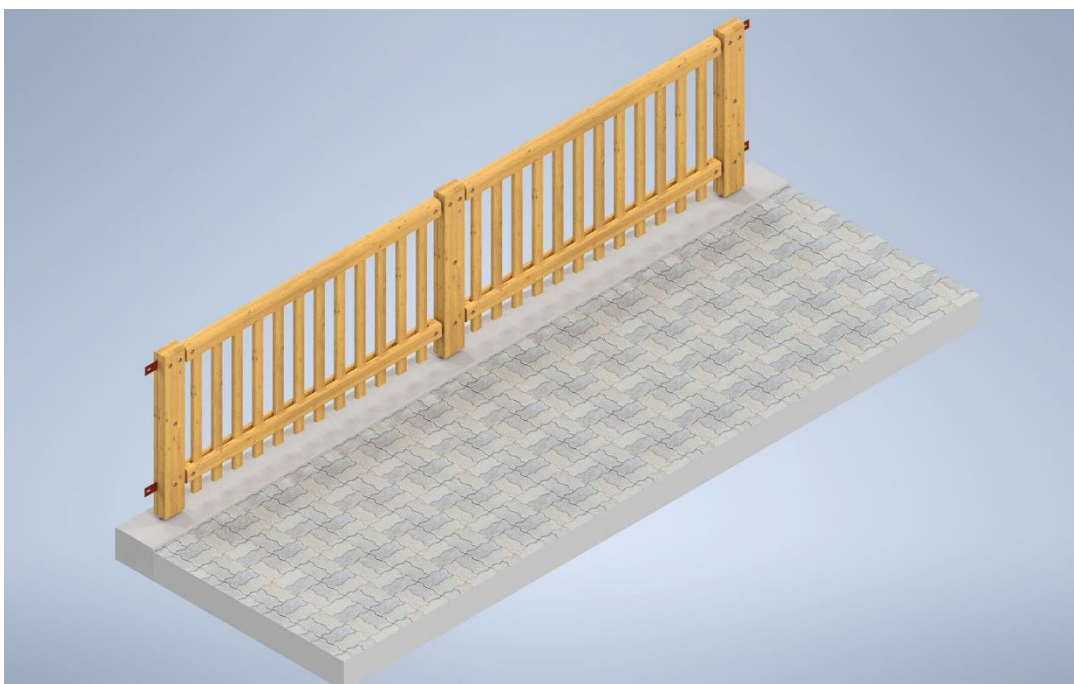
Figura 5. Montaggio del parapetto su fori predisposti nel cordolo di fondazione
