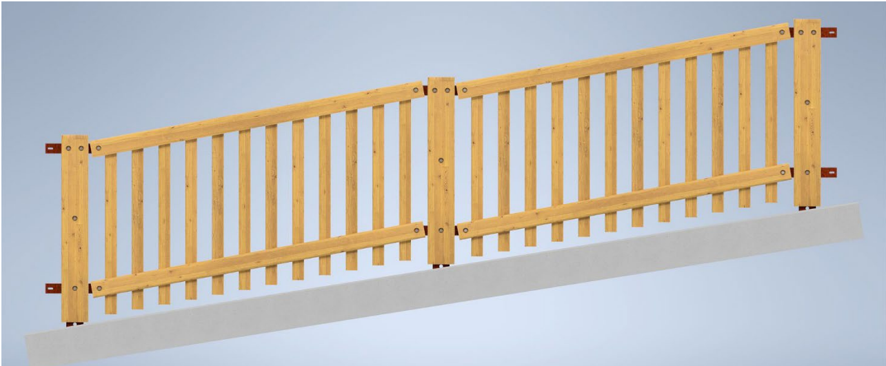
Figura 7. Montaggio del parapetto su fori predisposti con pendenza del 16 per cento
